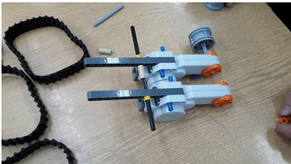
К оси прикрепляем колёса и фиксируем втулками, аналогично передним колесам. Теперь натягиваем гусеницы на колёса. После этого надо взять изогнутые балки закрепить на двигателях
