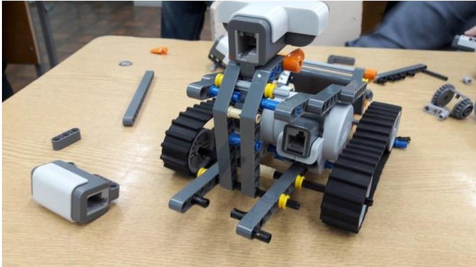
Устанавливаем датчик света. Соединяем все датчики кабелями с блоком NXT. Робот-сумоист готов!
