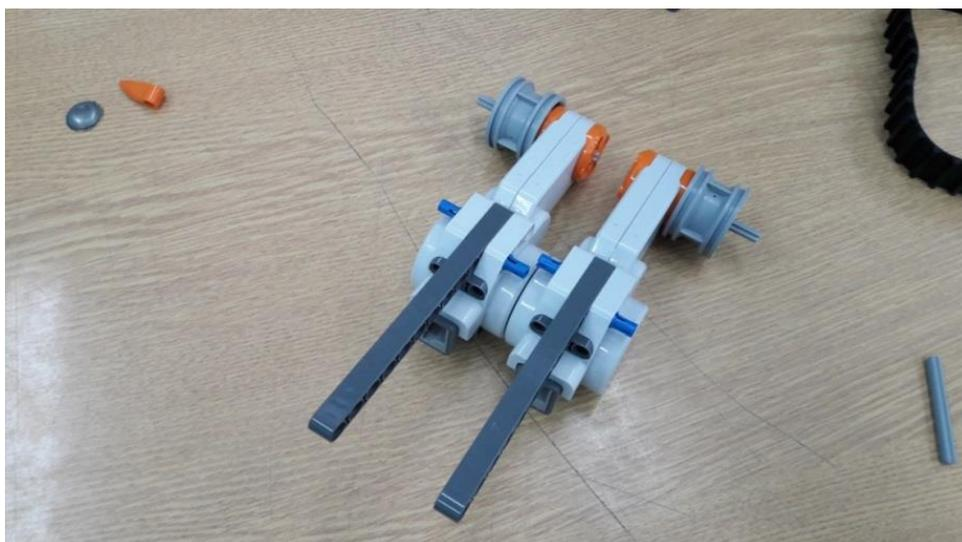
Фиксируем балки осью, а ось закрепляем втулками, как показано на картинке.
